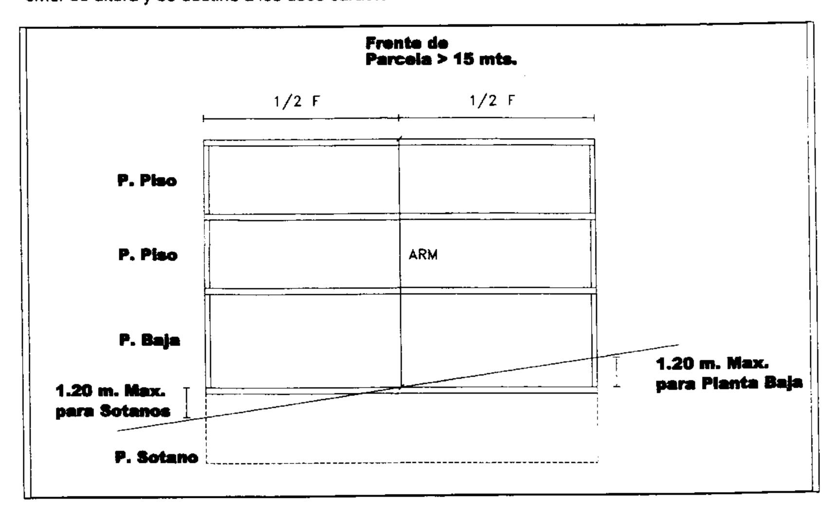
C.- Planta: Es la proyección horizontal de las superficies edificadas comprendidas dentro de los límites exteriores definidos por los planos de fachada reales o virtuales verticales o inclinadas. Dentro de una misma edificación se pueden distinguir las siguientes plantas:
