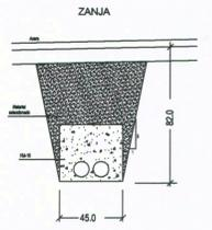
Sección zanja Telecomunicaciones 2 Conductores Ø110 P.V.C.
