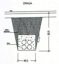
Sección zanja Telecomunicaciones 4 Conductores Ø110 P.V.C.
