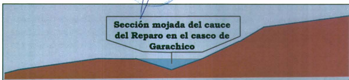
Gráfico 37. Sección de desagüe del cauce del barranco del Reparó en las inmediaciones del casco urbano de Garachico.
