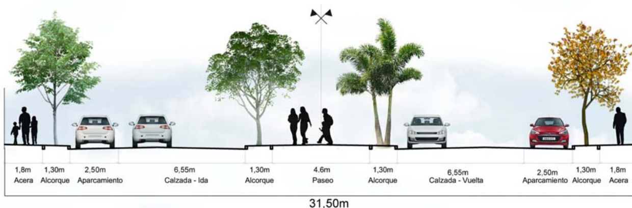
Sección tipo de la Vía de Conexión
