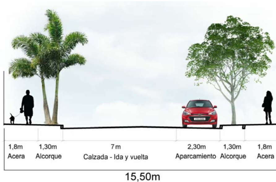
Sección tipo de la Vía de Distribución
