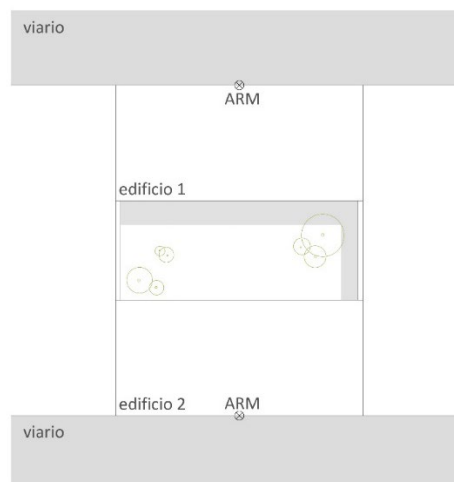
Imagen: Criterios para el establecimiento de la cota de referencia. Edificación cerrada y semicerrada con frente a dos vías y espacio libre interior de manzana.
