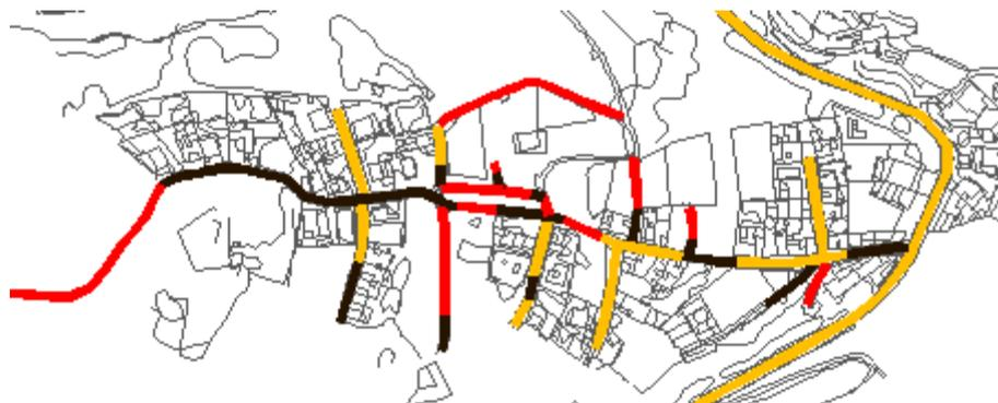
Imagen 8.3.2.2.2-2: Secciones de vías rodadas: Calle El Escobonal. Línea roja: menos de 3 m, línea marrón: entre los 3 a 5 m, línea naranja: entre los 5 a 7 m, línea cian: entre los 7 a 9 m, línea azul: entre los 9 a 12 m, línea verdes oscuro: entre los 12 a 15 m. Elaboración propia.
