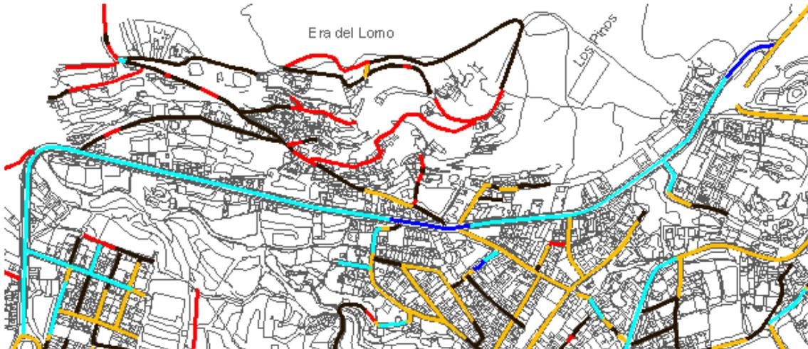
Imagen 8.3.2.2.1 - 8: Secciones de vías rodadas: Avenida del Cabildo Insular. Línea roja: menos de 3 m, línea marrón: entre los 3 a 5 m, línea naranja: entre los 5 a7 m, línea cian: entre los 7 a 9 m, línea azul: entre los 9 a 12 m, línea verdes oscuro: entre los 12 a 15 m. Elaboración propia.
