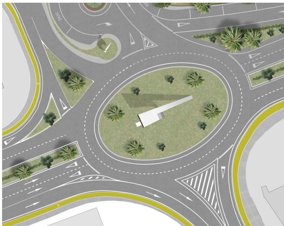
Vista en planta del diseño del nuevo nudo viario en la carretera GC-500. Elaboración propia.
