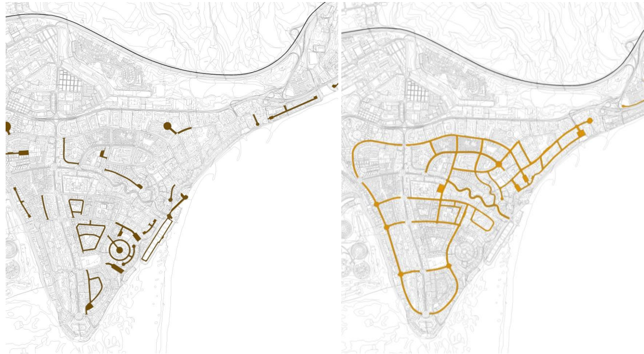
Esquema de vías de segundo orden (izquierda) y esquema de vías de tercer orden (derecha). Fuente: PMM de Maspalomas Costa Canaria.
