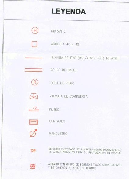
NOTA: LA RED DE RIEGO UTILIZARÁ PRINCIPALMENTE EL AGUA DE PLUVIALES ALMACENADA EN EL DEPÓSITO ENTERRADO Y DISPONDRA DE UNA SENGUNDA CONEXIÓN A LA RED GENERAL, PARA ABASTECER EL SERVICIO DE RIEGO EN CASO DE INSUFICIENCIA DE AGUA ALMACENADA.
